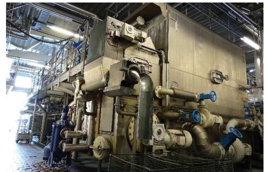
Fig. 2: Lavadora de botellas KRONES modelo Lavatec KES 3-4, 46.000 botellas/h
