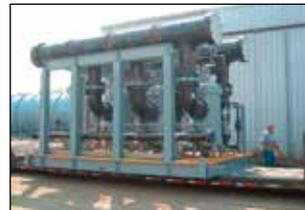
Filteranlage für „Injection Water“ mit drei BOLLFILTER Automatik TYP 6.18, DN 400
